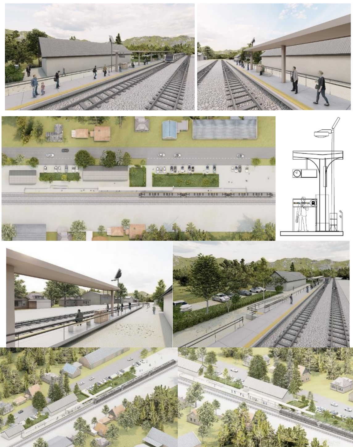
Figura 3.2-7. Exemplu mod de organizare a unui punct de oprire
